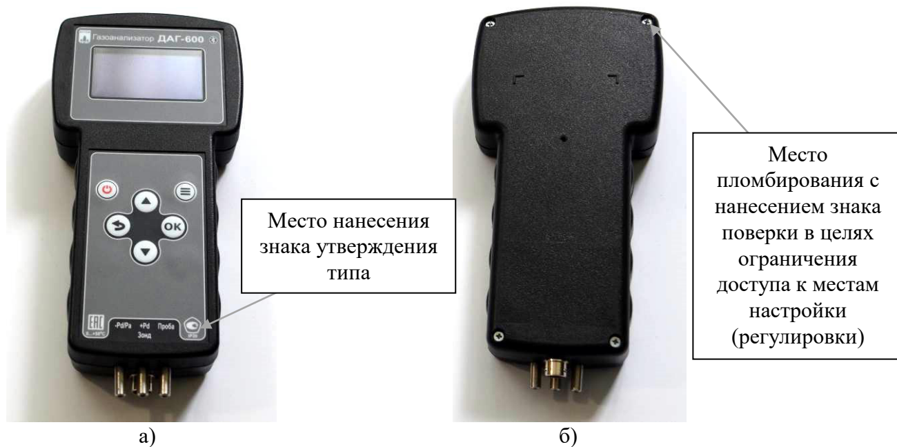
Рисунок 1 – Общий вид газоанализатора ДАГ-600 с указанием места нанесения знака утверждения типа и места пломбирования и нанесения знака поверки в целях ограничения доступа к местам настройки (регулировки)
