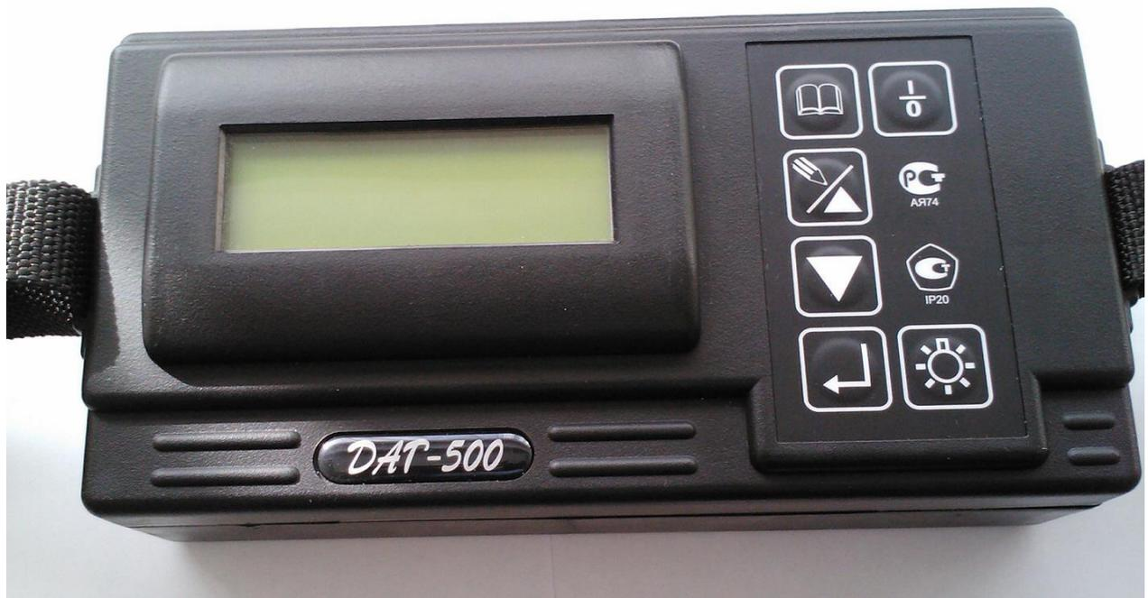
Рисунок 1 - Общий вид газоанализатора ДАГ-500.
